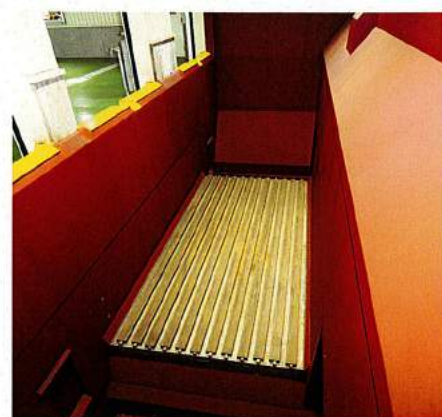
②受入ホッパ(本体・供給装置) 搬入されたごみを投入し、受入ホッパの底の供給装置で搬送コンベヤに送ります。
