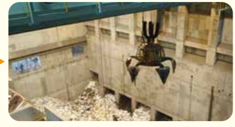
2 2 ごみクレーン・ごみピット 2 ごみクレーン・ごみピット ごみピットに貯められたごみは、ごみクレー ンにより、焼却炉に投入されます。
